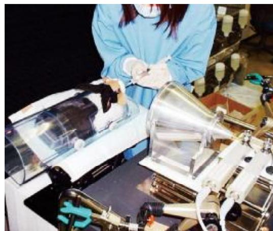
電磁波暴露実験装置
