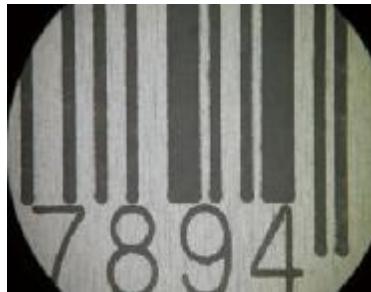
JANコード 測定顕微鏡30倍画像 黒いバーの輪郭がハッキリとマーキングされています
