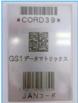
各種バーコードマーキング 上から、コード39 GS1 データマトリックス JANコード
